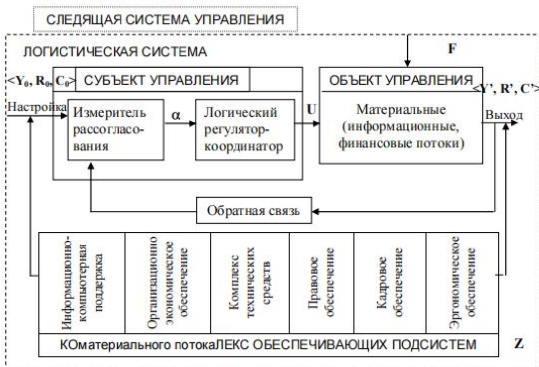
Рисунок 5 - Представление логистической системы в качестве следящей системы управления: Y_0, R_0, C_0 – векторы входных потоков; \alpha – рассогласование; U – вектор управляющих воздействий на объект; Y', R', C' – векторы параметров выходных потоков
